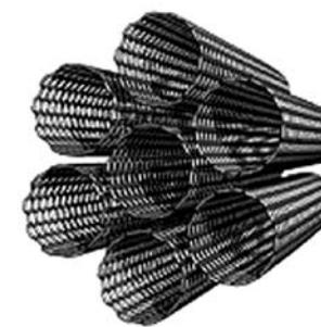
Рис. 1.25. Микрофотография и атомная модель пучка нанотрубок
